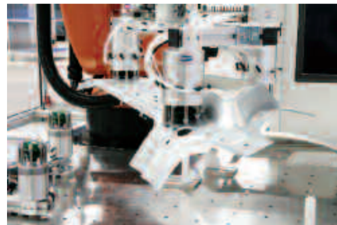
6. Kombinacijo prijemalne glave z vakuumskim prijemalom in vpenjalnega sistema se hitro vgradi v proizvodno linijo. Na koncu se lahko pritrdi obdelovanec.
