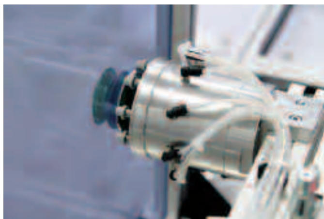
2. Prvi podporni čep se ustavi v ničelni točki.
