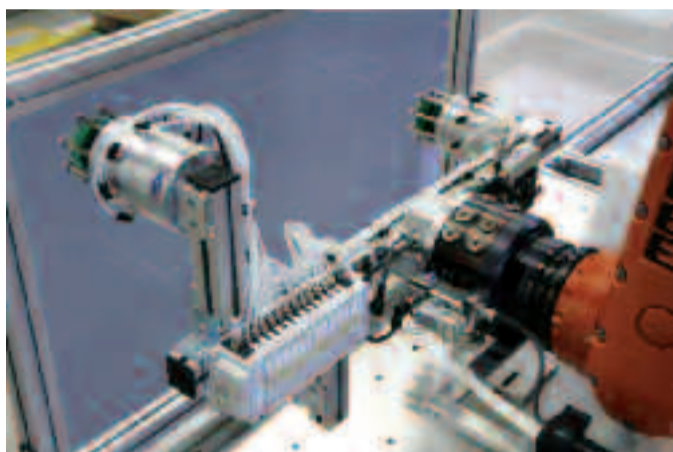
1. Prijemalna glava (angl. suction cup spider) se namesti glede na referenčno ravnino. Nastavitev ničelne točke se nato določi glede na CAD-geometrijo obdelovanca.
