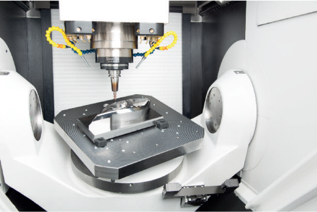
Nagibna vrtliva miza z direktnimi pogoni z vodnim hlajenjem.
