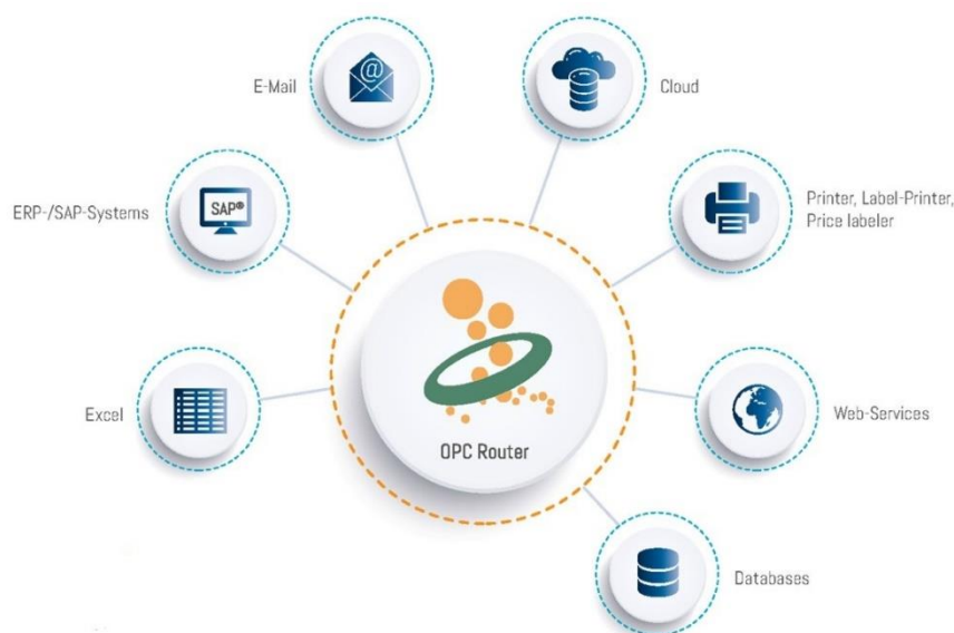
Slika št. 2: OPC Router deluje kot usmerjevalnik z dvosmerno komunikacijo.
