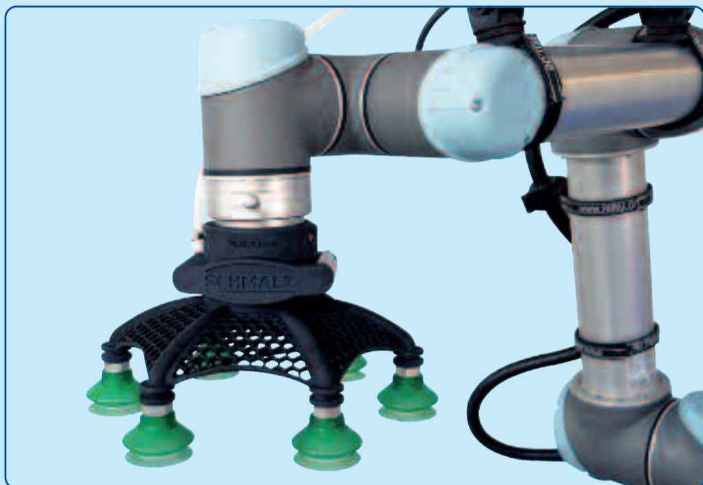
Prijemalo SCHMALZ SLG je izdelano s postopki 3D-tiskanja
